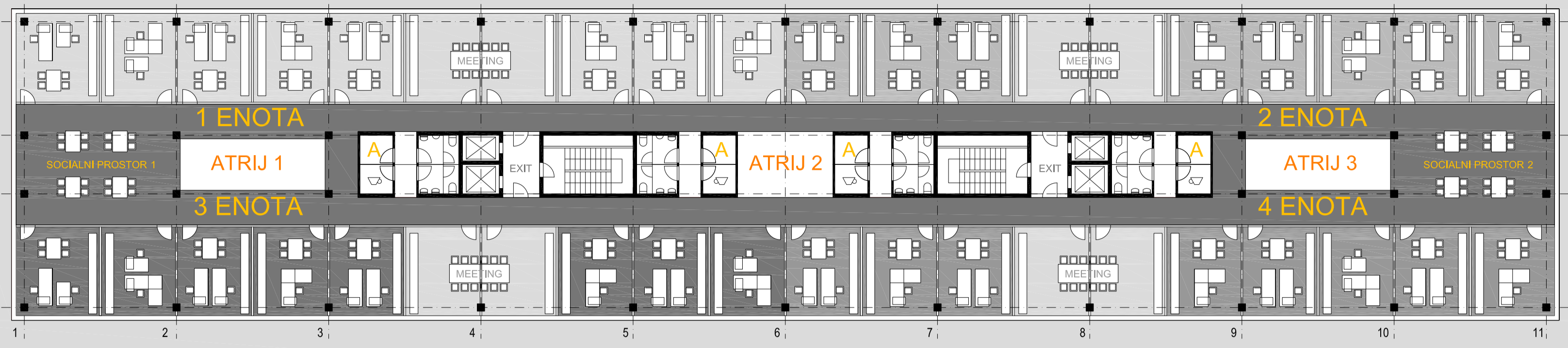
FE 3/1 FE 3/4 -P.4.Z BRUTO POVRŠINA POSAMEZNE PISARNE KI SE ZDRUŽUJE V ENOTO-20M2 BRUTO POVRŠINA POSAMEZNEGA POSLOVNEGA PROSTORA OZ. LOKALA-55M2 (1 ENOTA) BRUTO POVRŠINA SKUPNIH PROSTOROV (KOMUNIKACIJE, SERVISI, HODNIKI...) - 557M2 BRUTO POVRŠINA PARKIRNE GARAŽE-3167 M2
